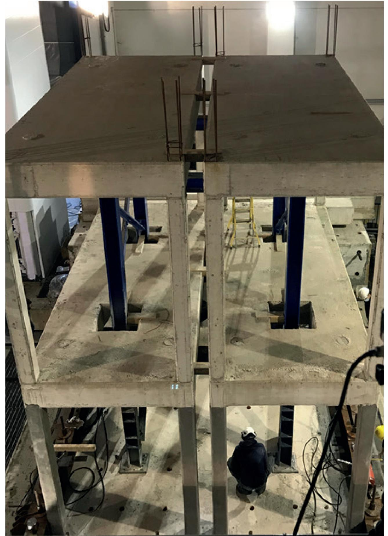
FIGURA 68 - Telai degli edifici in c.a. non ancora tamponati e con telaio di sicurezza interno in acciaio durante le fasi di trasporto e di posizionamento su tavola vibrante.
