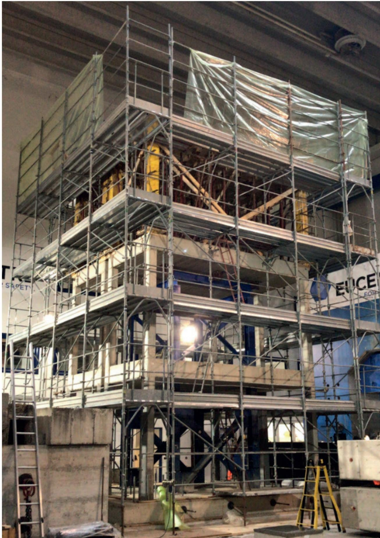
FIGURA 69 - Fase di realizzazione del terzo piano dei telai in c.a. degli edifici posizionati su tavola vibrante.
