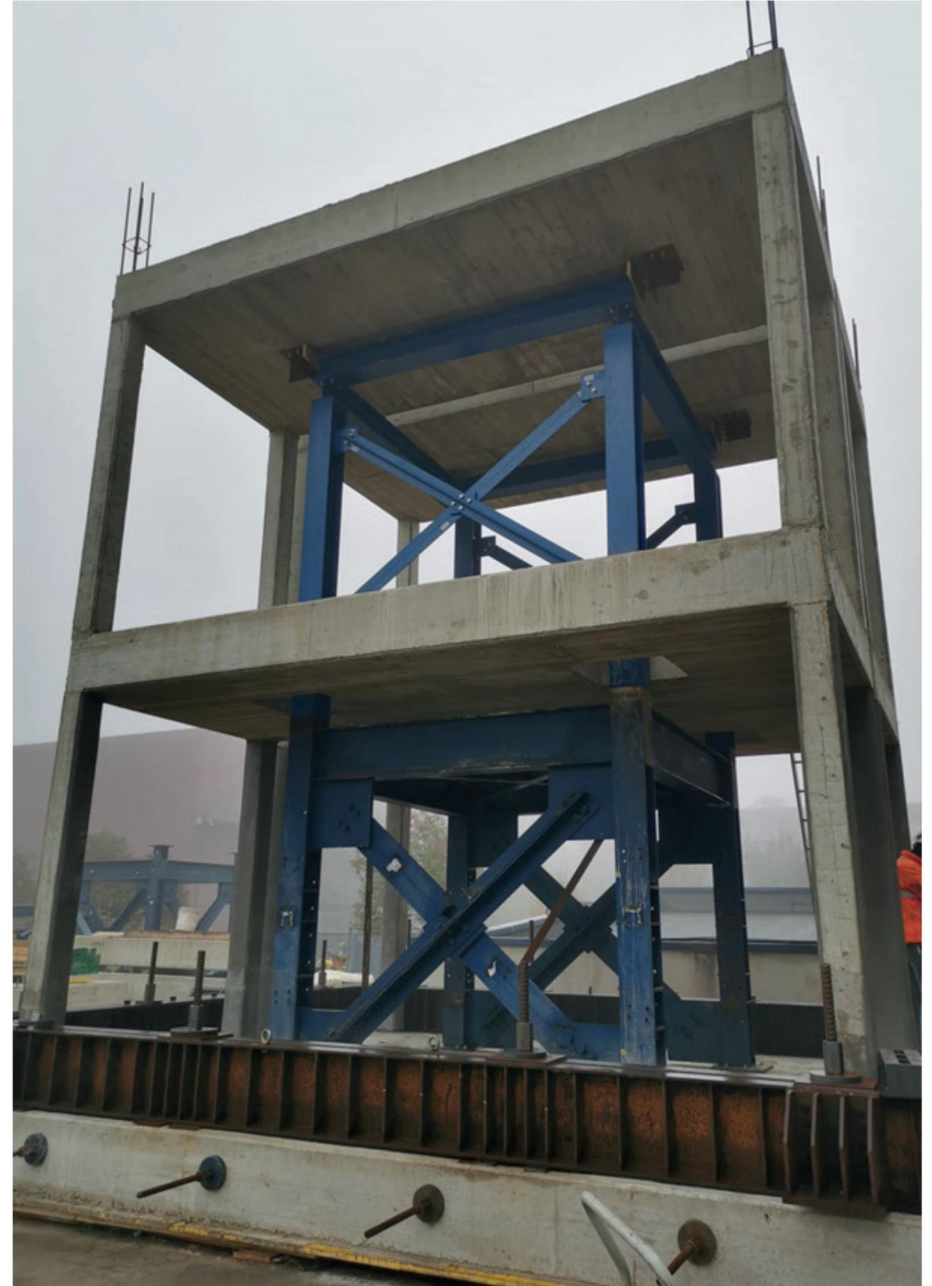
FIGURA 66 - Telai degli edifici in c.a. non ancora tamponati e con telaio di sicurezza interno in acciaio prima del trasporto su tavola vibrante.
