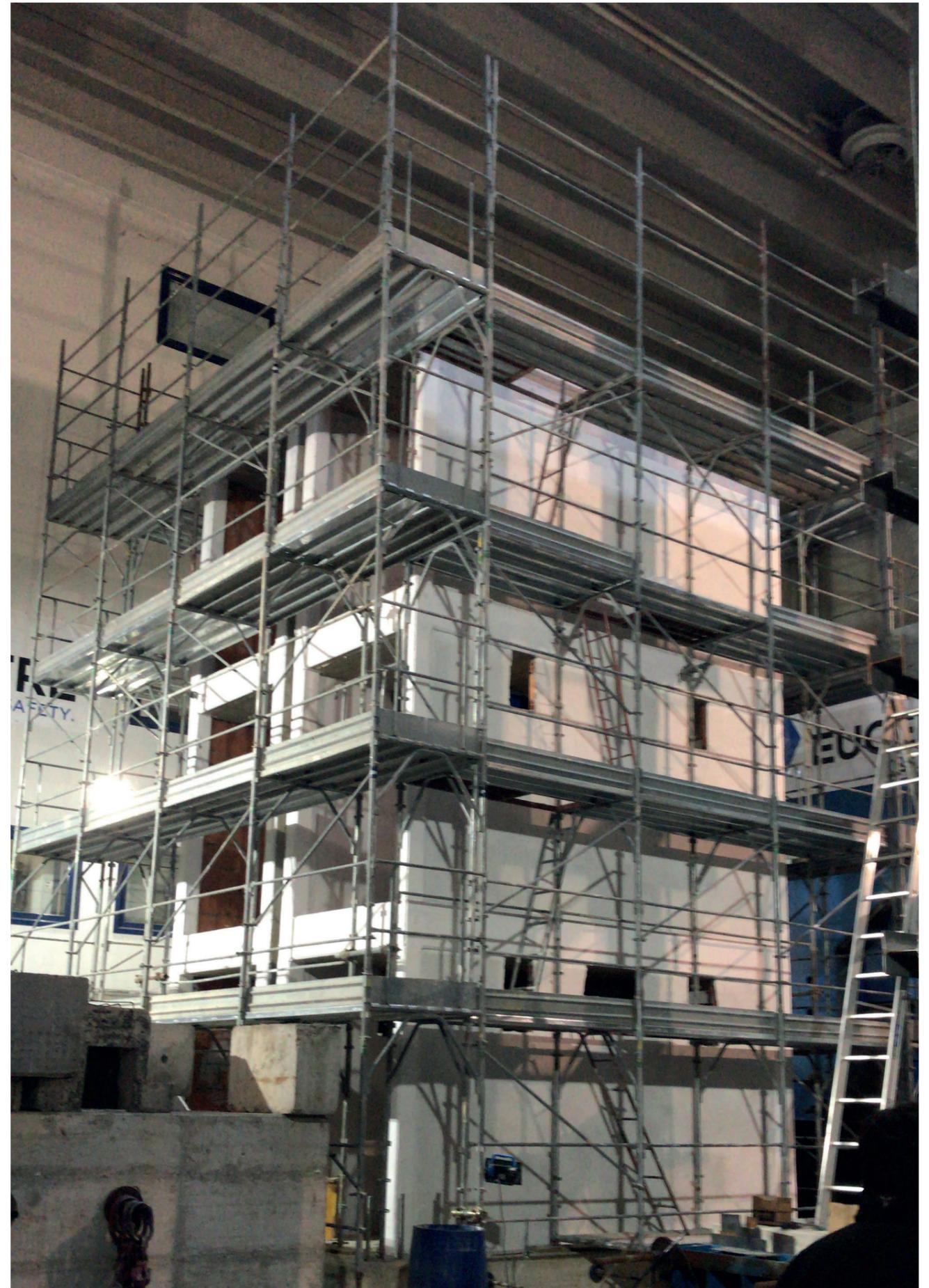
FIGURA 72 - Telai degli edifici in c.a. tamponati durante le ultime fasi di realizzazione all'interno dei laboratori.
