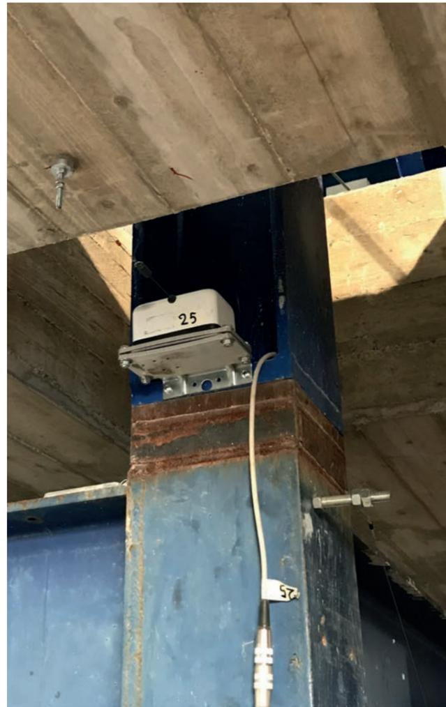
FIGURA 9 - Sensori di spostamento a filo installati: (a) Sensore montato tra carpenteria di sicurezza e primo solaio della struttura con sistema I-Pro 1; (b) Sensore montato tra carpenteria di sicurezza e primo solaio della struttura normale.
