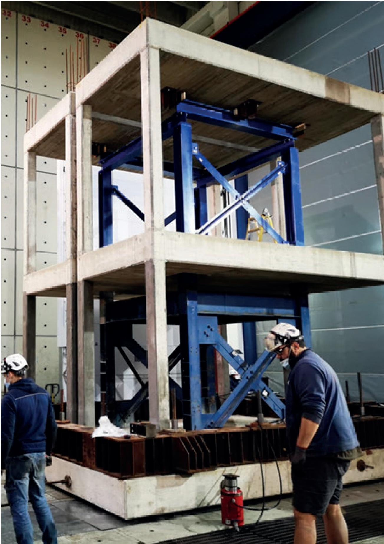
FIGURA 67 - Telai degli edifici in c.a. non ancora tamponati e con telaio di sicurezza interno in acciaio durante le fasi di trasporto e di posizionamento su tavola vibrante.
